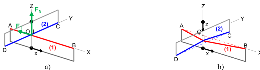
Figure 1: Schéma du contact entre deux fibres de carbone (en rouge et en bleu) : force normale le long de l'axe Z et force tangentielle le long de l'axe X au cours d'un test de frottement avec un déplacement le long de l'axe X, a) sans déformation et b) avec déformation des fibres.
